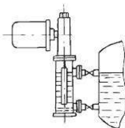
*Рисунок Г.2 – Установка преобразователя на выносной камере*
