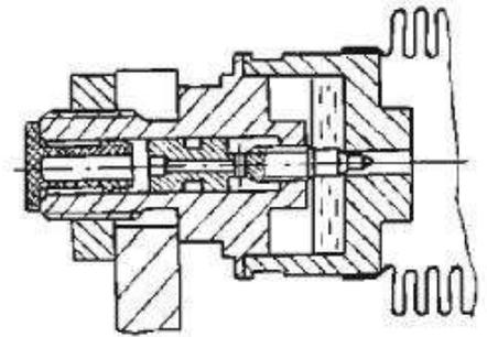
Рисунок В.3 – Конструкция демпфера
